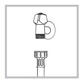
1. Conecte el tubo de alimentación enroscándolo a un grifo de agua fría con la boca roscada de 3/4 gas (ver la figura).
